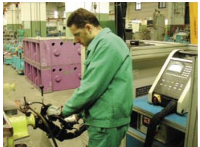
Snabb, exakt och med övervakning av temperaturen. EFD Inductions induktiva verktyghärdutrustning minimerar deformationer och ger en bra arbetsmiljö.
